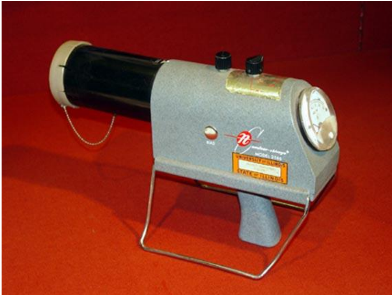
Chambre d'ionisation "Cutie Pie" de Nuclear Chicago
