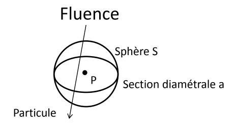
Soit N, nombre moyen de particules monodirectionnelles pénétrant une sphère S finie entourant un point P durant un intervalle de temps  $\Delta t$  entre un temps  $t_0$  et un temps  $t \to S$  la sphère est réduite au point P (section diamétrale  $da \perp a$  la direction de propagation des particules)  $\to$  définition de la **fluence (de particules)**  $\Phi$ : quotient de dN par da (unité:  $m^{-2}$ )  $\to$
