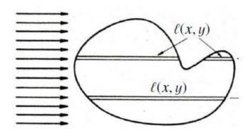
Divisons un volume V traversé par N particules en tubes de section da et de longueur l(x,y) avec le plan OXY  $\bot$  à la direction des particules  $\rightarrow$  au point (x,y): la section du tube est traversée par dN particules. Par définition de la fluence  $\rightarrow dN = \Phi da \rightarrow$  remarquant que la somme des longueurs des traces dans un tube  $ds = \sum_i l_i = l(x,y)dN \rightarrow ds = l(x,y)\Phi da = \Phi dV$  puisque  $dV = l(x,y)da \rightarrow \Phi = ds/dV$
