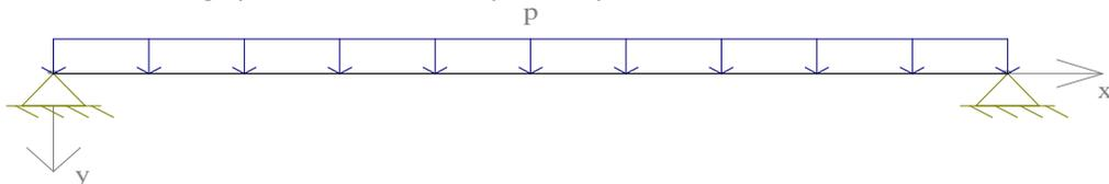
N.B. : Il est possible de déterminer la solution exacte pour vérifier les résultats numériques. A défaut, une autre vérification est donnée par la formule de la flèche  $f = \frac{5pL^4}{384EI}$ , ce qui correspond à la valeur maximale de la déformée, qui dans ce cas, se produit au milieu de la poutre.
