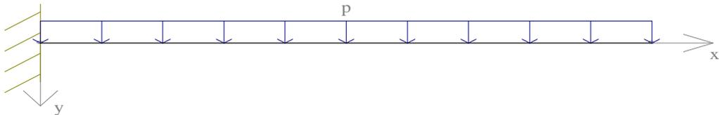
N.B. : Il est possible de déterminer la solution exacte pour vérifier les résultats numériques. A défaut, une autre vérification est donnée par la formule de la flèche  $f = \frac{pL^4}{8EI}$ , ce qui correspond à la valeur maximale de la déformée, qui dans ce cas, se produit à l'extrémité droite de la poutre.
